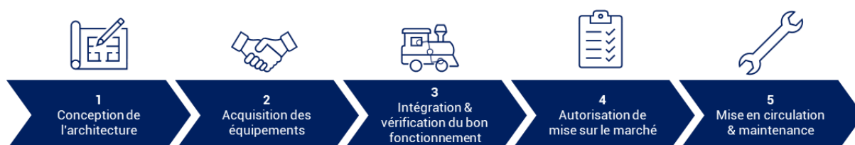
Fig. 18 Les différentes étapes de la mise en œuvre d'une architecture de sécurité embarquée en France
