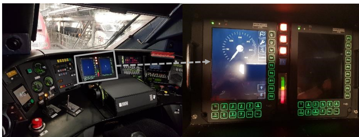
Fig. 6 Pupitre de la rame Thalys PBKA n°4344 où figurent les différentes interfaces homme-machine bord dont les DMI ERTMS (photo de droite)
