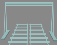
Passerelles de visite de toitures
